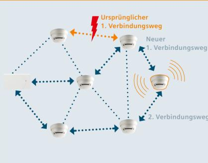
Ist ein Wechsel des Kanals oder Frequenzbandes nicht erfolgreich, werden die Informationen über einen anderen Weg umgeleitet. Die Zentrale zeigt es an, falls nur noch ein Verbindungsweg zur Verfügung steht. Diese Meldung verschwindet, sobald der zweite redundante Verbindungsweg wieder in Betrieb ist.
